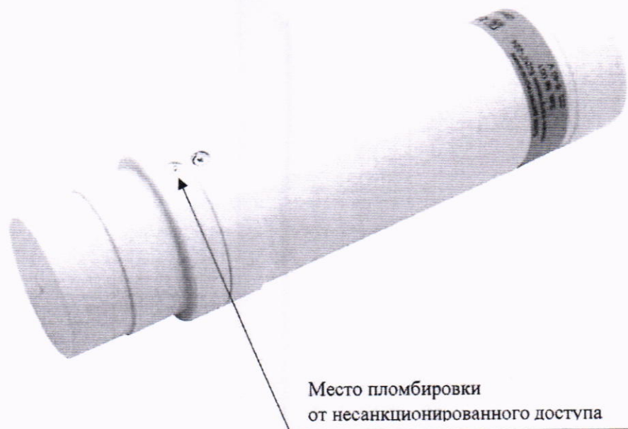
Рисунок 3.1 – Схема пломбировки от несанкционированного доступа
