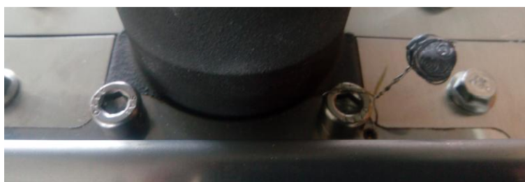
Рисунок 2а – Пломбировка основной маркировочной таблички пломбой завода-изготовителя
