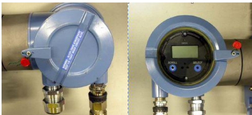
Рисунок 4 - Вариант пломбирования корпуса электронных преобразователей моделей 1700, 2700
