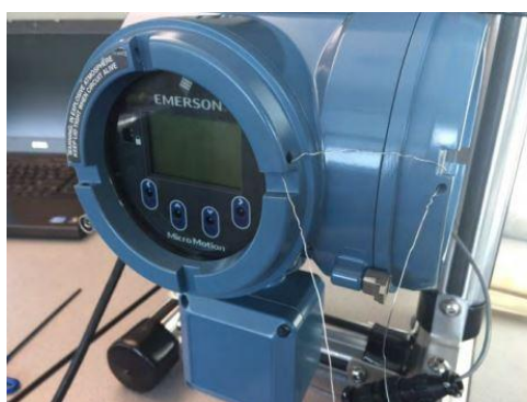
Рисунок 5 - Вариант пломбирования корпуса электронного преобразователя модели 5700
