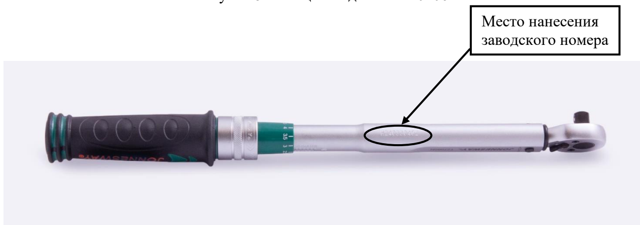
Рисунок 6 – Общий вид места нанесения заводского номера
