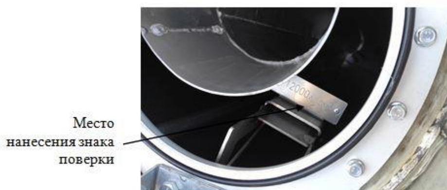
Рисунок 5 – Место нанесения знака поверки на указатель полной вместимости автотопливозаправщика
