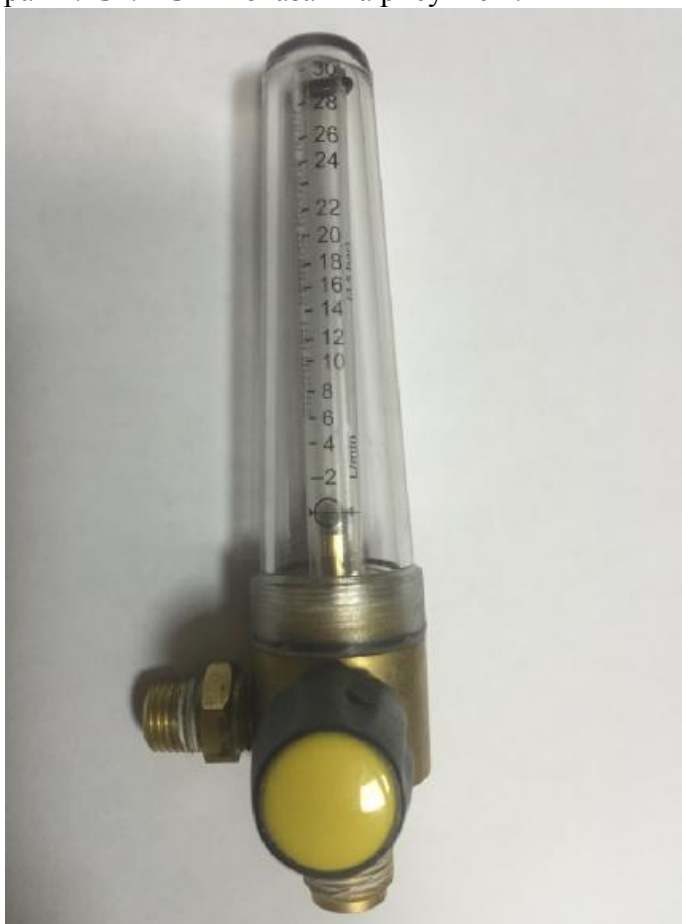
Рисунок 1 - Общий вид (фото) ротаметра RI.132.12541
