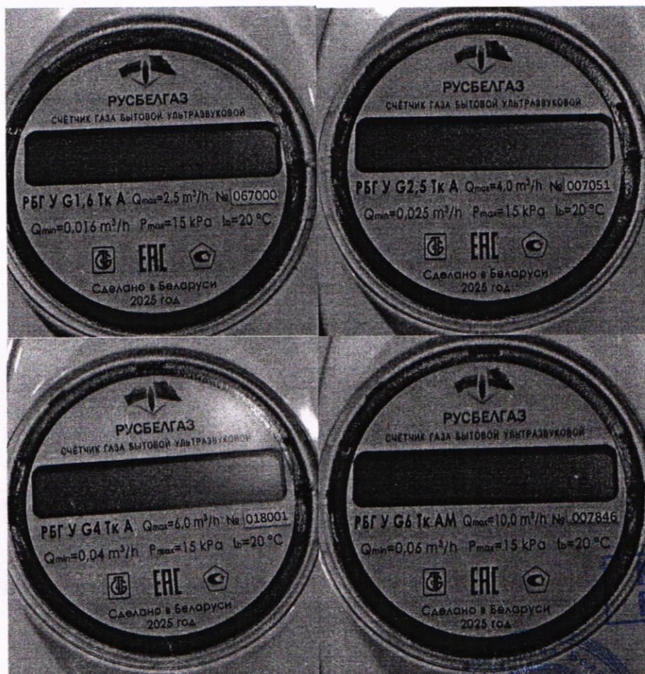
Рисунок 1.2 – Фотография маркировки счетчиков газа бытовых ультразвуковых РБГ У (изображение носит иллюстративный характер)
