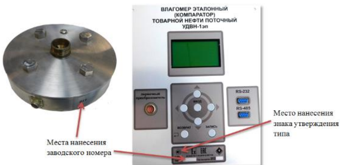
Рисунок 2 – Места нанесения заводского номера и знака утверждения типа влагомера
