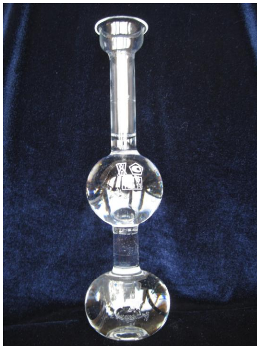
Рисунок 1 - Общий вид колб измерительных к вискозиметру типа ВУ (для определения условной вязкости)
