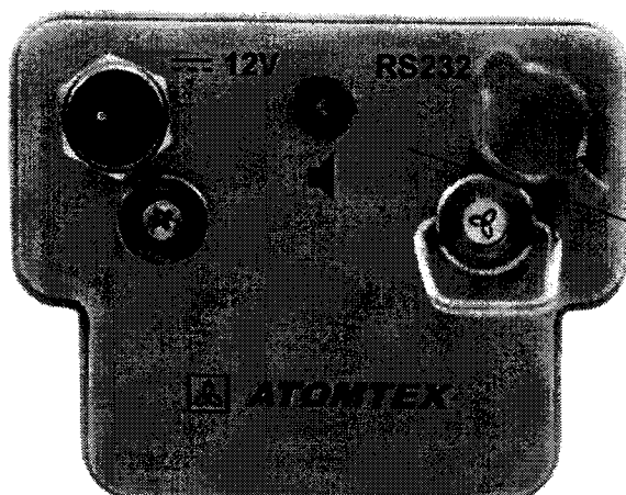
Рисунок 2 – Место нанесения знака поверки (клейма-наклейки) на дозиметр
